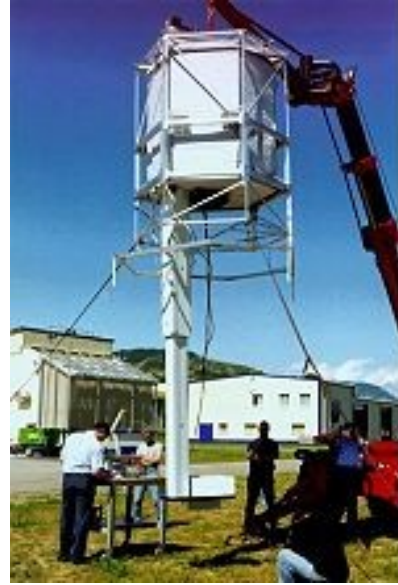
Photo 4 : L'instrument SPIRALE du LPCE (Orléans) est un spectromètre à diode laser d'un poids avec sa nacelle, d'environ 500 kg. Les profils verticaux de concentrations d'une douzaine d'espèces - O_3 , CH_4 , CO , CO_2 , N_2O , HNO_3 , NO_2 , NO , HCl , HOCl , H_2O_2 , COF_2 - sont mesurés avec une très grande résolution verticale (quelques mètres), une grande sensibilité (rapports de mélange > 10 pptv) et une grande précision. © LPCE
