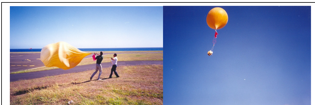
Photo 2 : Envoi d'une sonde PTU-Ozone à l'aéroport de Saint Denis de la Réunion. Le lâcher du ballon peut être problématique par vent fort © OPAR, Université de la Réunion
